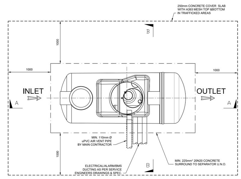
TYPICAL PLAN OF UNDERGROUND TANK
